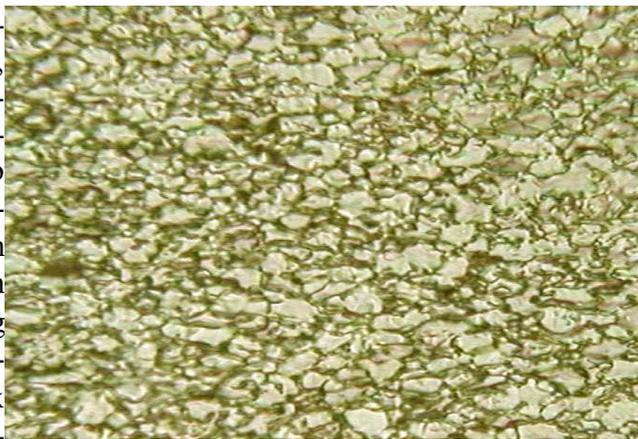
82. ábra. A 110.sz. minta mikrokristályos mátrixának szövete a  $S_bL_{\perp}$  metszet mentén. A szövet mérsékelt irányítottságot mutat, a szemcsehatárok hullámosak.
