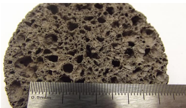
5. ábra: Geopolimer habtermék 1% Al-por habosítószer adagolás esetén
