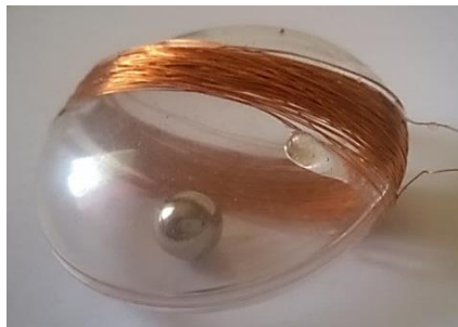
6.4. ábra. A mechanikus rezgőrendszer és elektromos indukciósrendszer deszkamodellje
