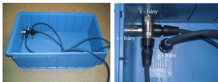
5.9. ábra. Egységgrakomány képző a gyorsulásmérő szenzorokkal
