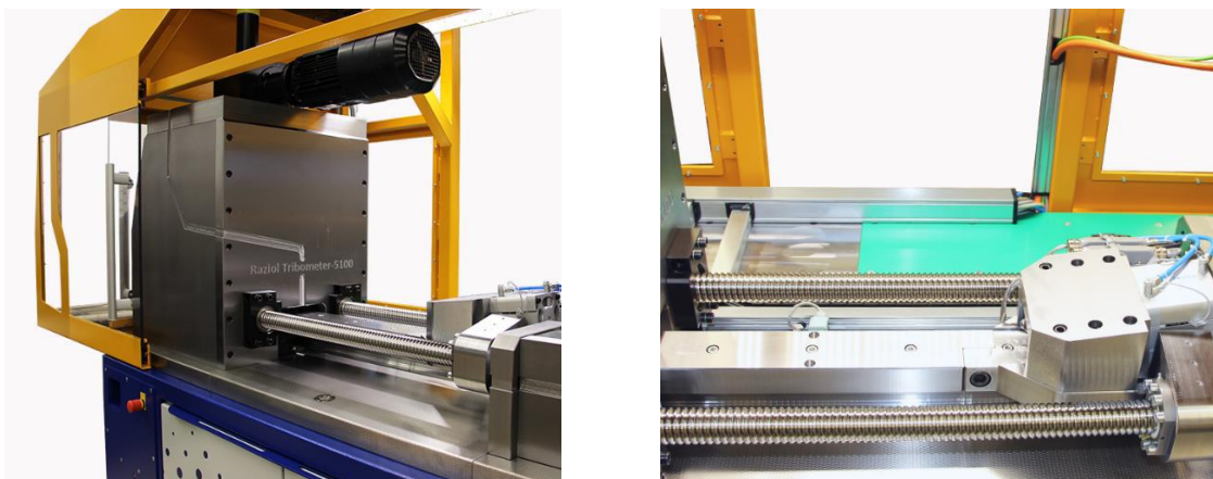
2. ábra. A Raziol cég által kifejlesztett Tribometer ® 5100 mérőberendezés.
