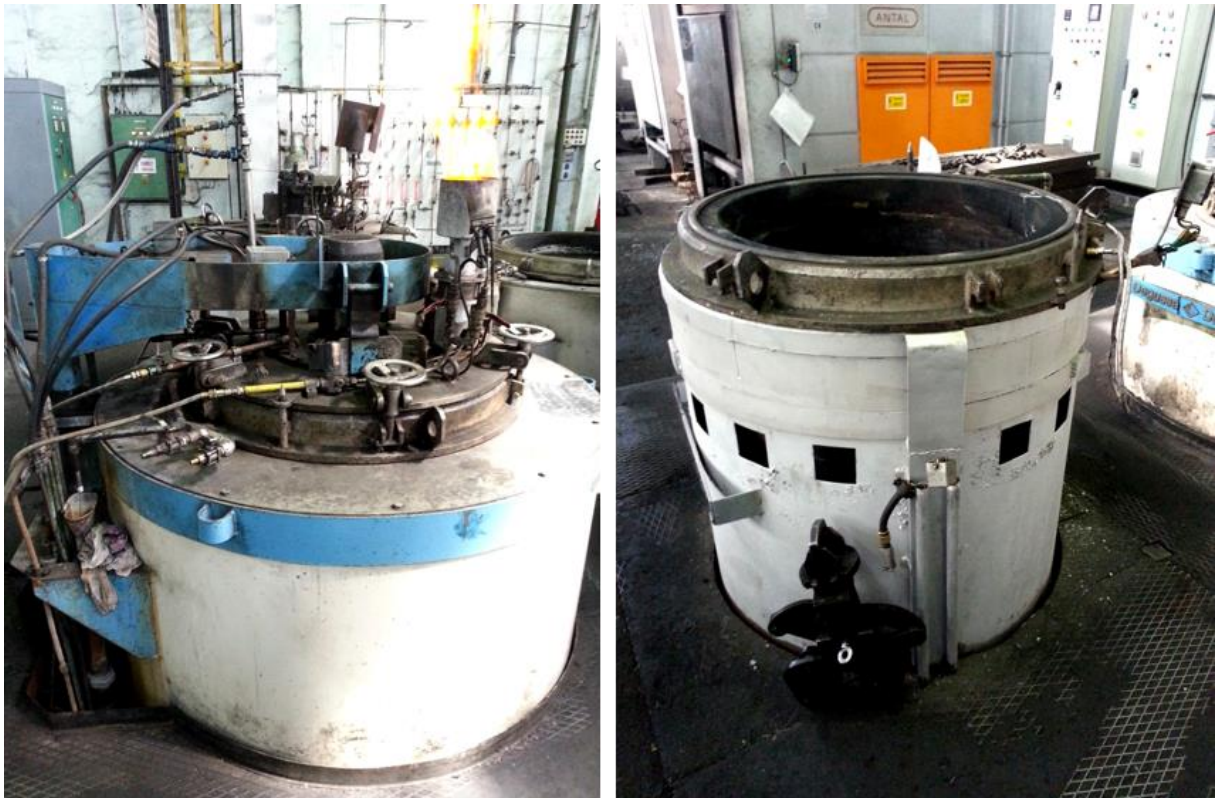
1. ábra. Fűtő és hűtő aknás retortás kemence a Csepeli Szerszámedző Kft.-ben
