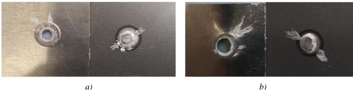
11. ábra. Kigombolódott kötések: a.) részleges kigombolódás, b.) teljes kigombolódás.
