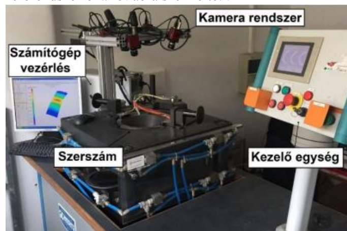
5. ábra. Lemezvizsgáló berendezés optikai mérőrendszerrel felszerelve.
