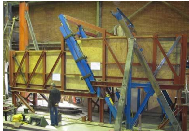
3. ábra. A talaj által közvetített, illetve a talaj mozgásából eredő terhelések csővezeték szakaszokra gyakorolt hatásának vizsgálata:
