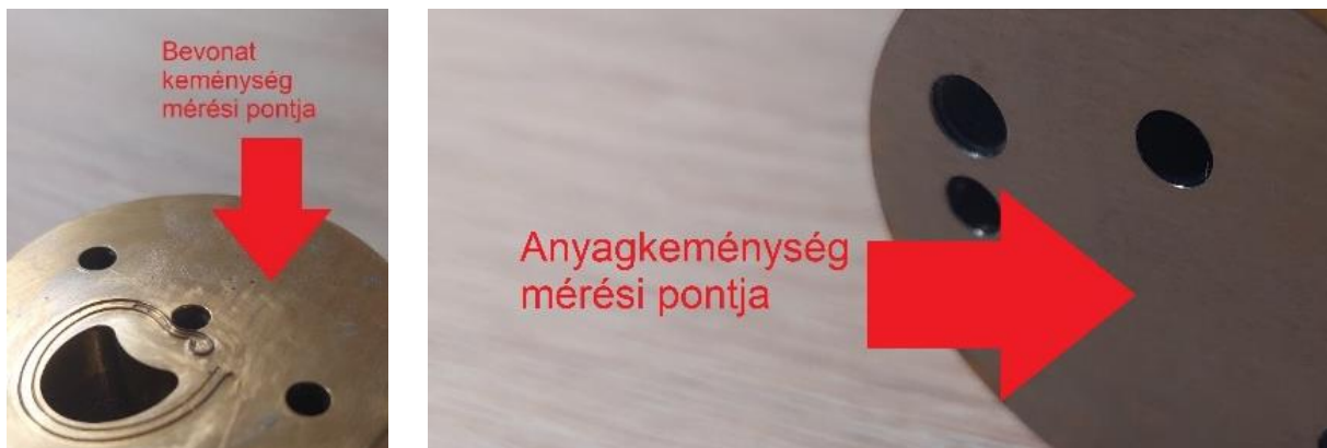
11. ábra. Perforáló szerszám elő- és hátlapja.
