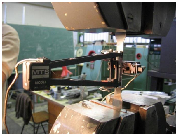
2. ábra. Egytengelyű húzóvizsgálat hossz- és keresztirányú méretváltozást mérő extenzométerekkel.
